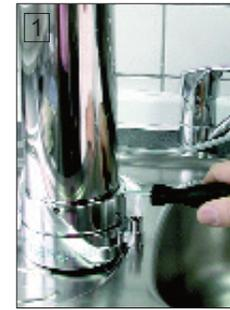
1. Schließen Sie den Wasserhahn. Dann halten Sie den Filtergehäusefuß fest und drehen mit dem Steckschlüssel den oberen Ring des Filtergehäuses nach links, bis dieser vollständig lose ist. Dann ziehen Sie diesen vorsichtig über das Filtergehäuse ab. Sollte die UMH-Kugel mit dem Auslaufbogen dabei stören, kann man diese vorher aus der Pfeife herausziehen.
