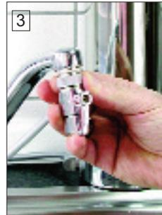
3. Schrauben Sie jetzt das Umlenkventil auf den Adapter und ziehen Sie es ebenfalls fest an. Der Schlauch verbindet den Auftischfilter ATE mit dem Wasser Ihrer Armatur.
